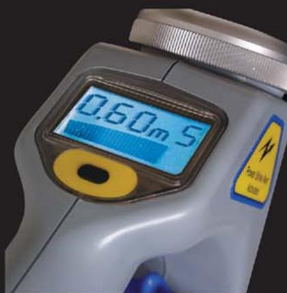
В режиме Sonde/CPS обнаруживаются сигналы от зонда или систем катодной защиты CPS (Cathodic Protection Systems).
