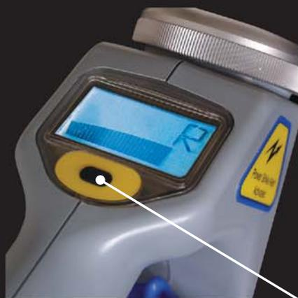
В режиме Radio приемник RD2000 обнаруживает сигналы очень низкой частоты, наведенные на подземные металлические трубопроводы и кабели радиостанциями.
