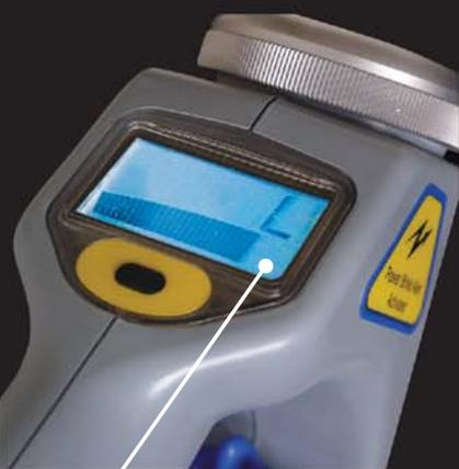
В режиме активной линии Line приемник RD2000 обнаруживает тональный сигнал, излучаемый генератором T1 в подземный проводник.
